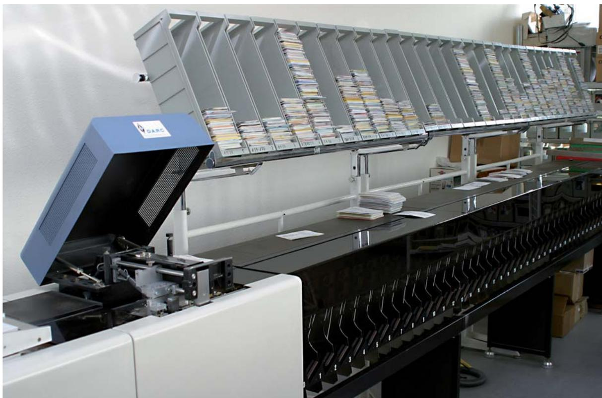
Die QSL-Sortieranlage mit ihren insgesamt 41 Fächern. Darüber befinden sich die Belegbehälter, in die die Karten nach Beendigung des Sortiervorganges umgefüllt werden
