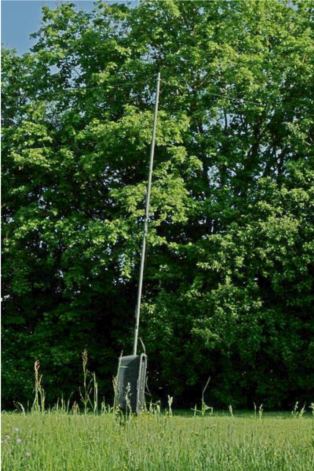
Die Antenne: Eigenbau mit Feldkabel und Smartuner SGC 230 von 3-30 MHz
