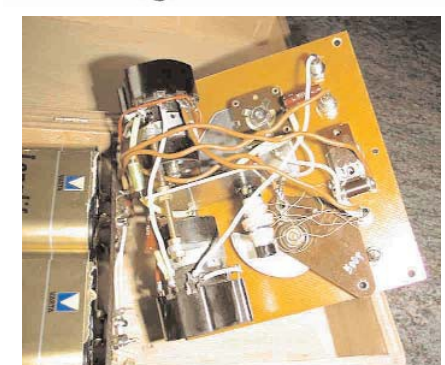
Eigenbauprojekt nach RIM Bau-mappe mit ausgezeichneter Empfangsleistung. Ein Vorläufer der heutigen Taschenradios
