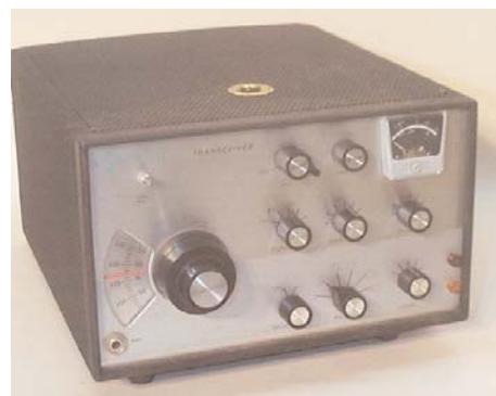
GALAXYVMK II 400 Watt PEP in SSB - 300 Watt in CW Trifft nach einer Anheizzeit 15 Min. weniger als 100 Hz Stroversorgung 800V; 350V; -100V und 12,6 VDC sowie 12,6 VAC
