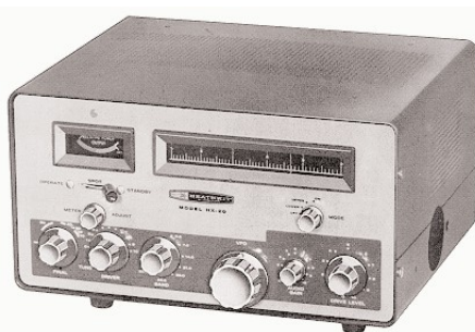
Heathkit HX20 90WSSB, CW Sender 7,5 kg 307x155x253mm
