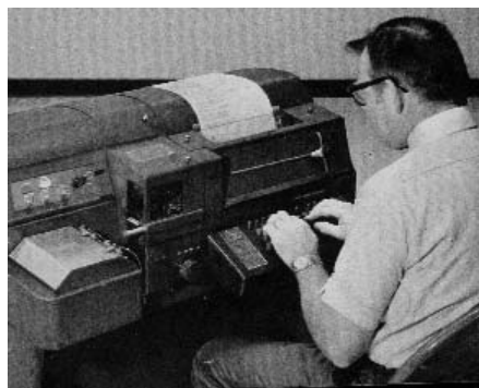
Fernschreiber mit Lochstreifenstanzer und -sender
