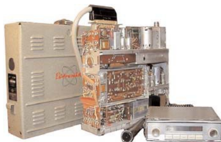
Bosch KF-T160 Taxifunkgerät 150-155 MHz 6 oder 12 Watt 2 Kanäle FM
