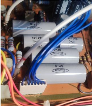
Bild 3: Ölpapierkondensatoren, Japanischer Herkunft im noch eingebauten Zustand.
