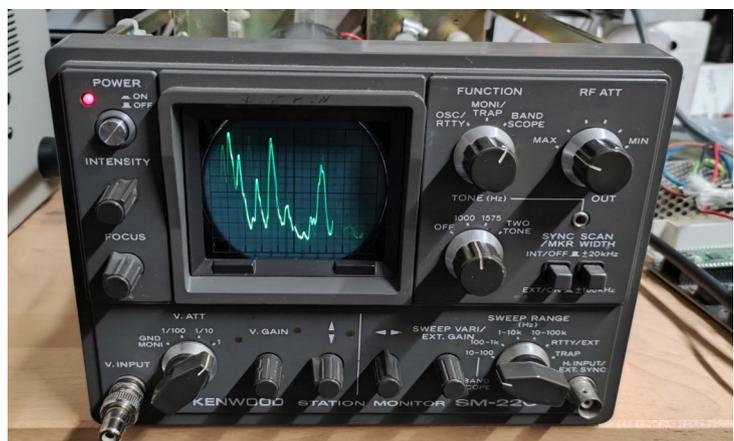
Bild 2: Bandscanner in Betrieb. Der Strahl ist nicht ganz zu sehen, da die Belichtungszeit der Kamera hier zu kurz ist.
