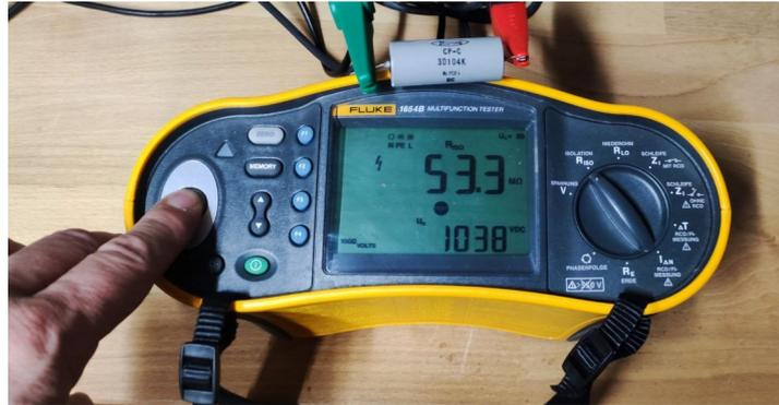
Bild 4: Auf dem Prüfstand: Prüfspannung 1000V, Isolationswiderstand 53MOhm
