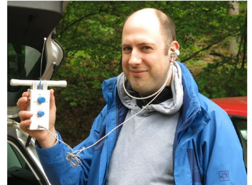
Peilempfänger → tragbarer Empfänger zum Aufspüren der Füchse
