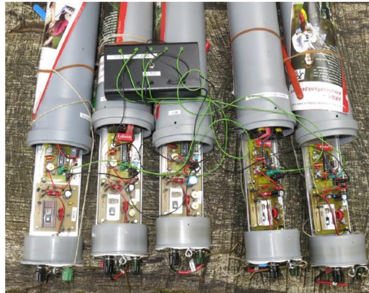
Sender bei 3,5 MHz (80 m Band) → Füchse, die versteckt werden
