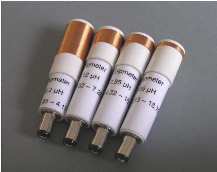
Bild 3: Spulen L_x , von links nach rechts: 19,2 \mu\text{H} , 6,12 \mu\text{H} , 2,95 \mu\text{H} und 0,89 \mu\text{H}
