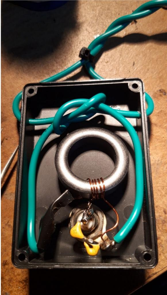
Für die Anpassbox wurde ein KEMO Kunststoffgehäuse, G025N, 72x50x22 mm, Thermoplast/PS verwendet. Darin wurde ein Ferrit-Ringkern FT184-43<sup>1)</sup> eingebaut.
