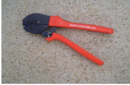
Bild 2 +3 Krimpzange für 3 Kontaktgrößen 15A, 30A, 45 A
