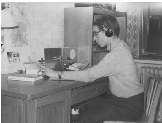
Mit Unterstützung durch Günther, ex-DL1JA (sk) baute ich einen Rückkopplungseinkreiser OV1 mit zwei EF80 nach Schultheiß. Ein Europasockel bekam den Pappkern einer Klopapierrolle für die Spule. Mit den Wicklungen nach Buch landete der Empfänger auf Antrieb im 80m-Band. Durch den örtlich sehr nahen Mittelwellensender brauchte ich vor dem OV1 unbedingt einen Sperrkreis, der dessen Frequenz von 971 kHz unterdrückte.
