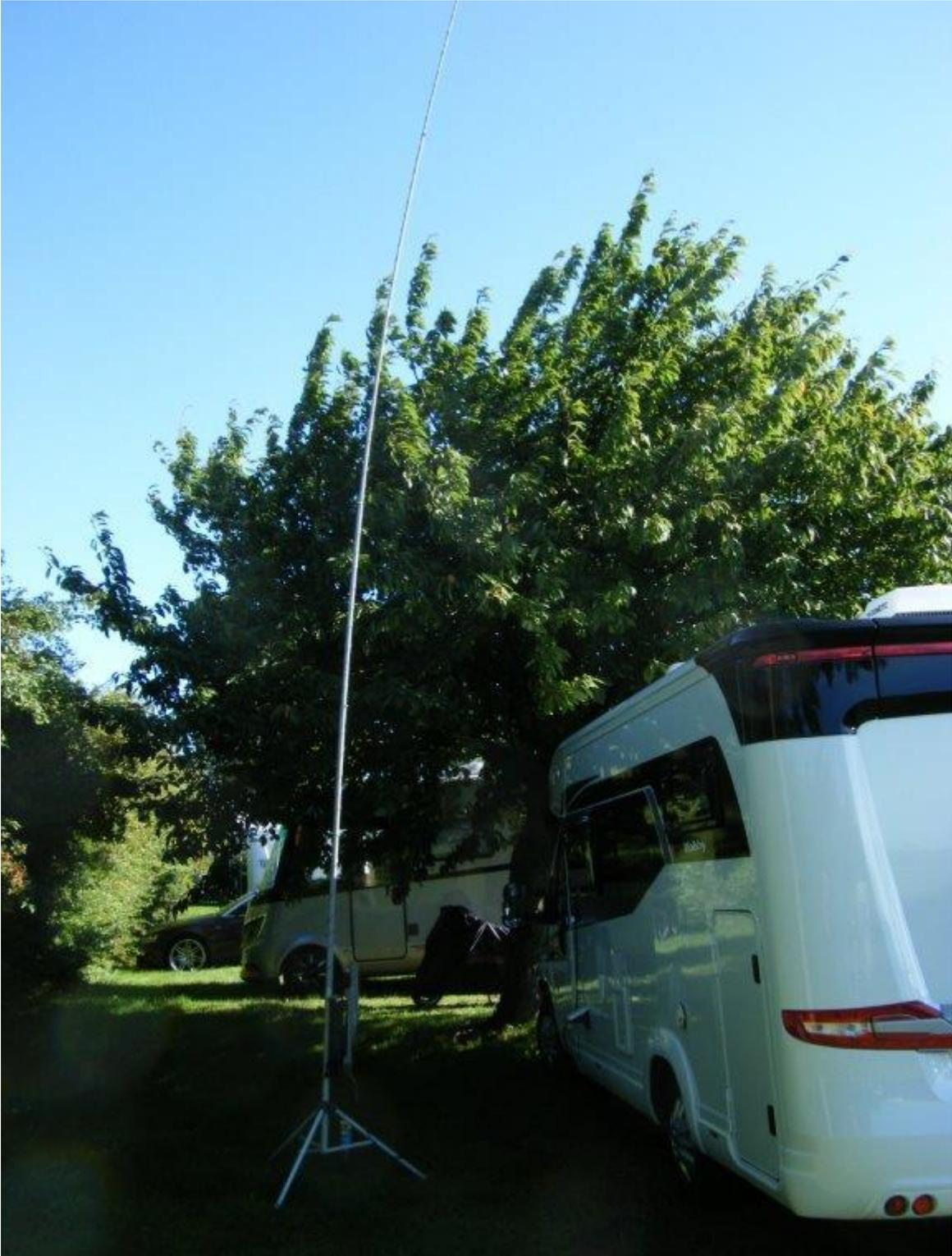
Diese Vertikalantenne muss lediglich bei **Sturm** abgespannt werden, das Stativ ist durch entsprechende „Heringe“ im Allgemeinen in der Lage den Antennenaufbau sicher zu halten.
