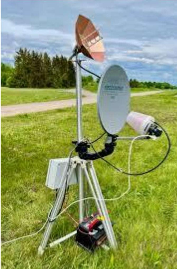
In der nebenstehende Abbildung sieht man die Ausrichtung der Antennen in Abhängigkeit der Art des Spiegels sehr deutlich. Beide Antennen sind auf den QO100 Satelliten ausgerichtet. Die obige Antenne (kupferfarben) ist eine einfache parabolische Antenne und dient in dieser Anordnung zum Senden.
