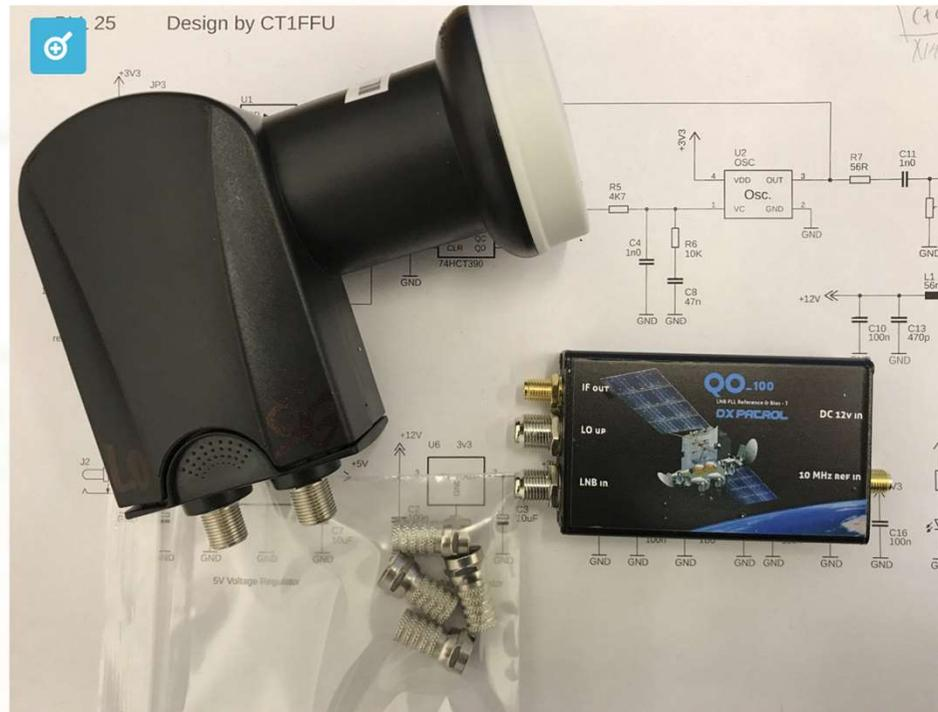
LNB und BIAS, Takterzeugung sowie Impedanzanpassung 75 Ohm auf 50 Ohm
