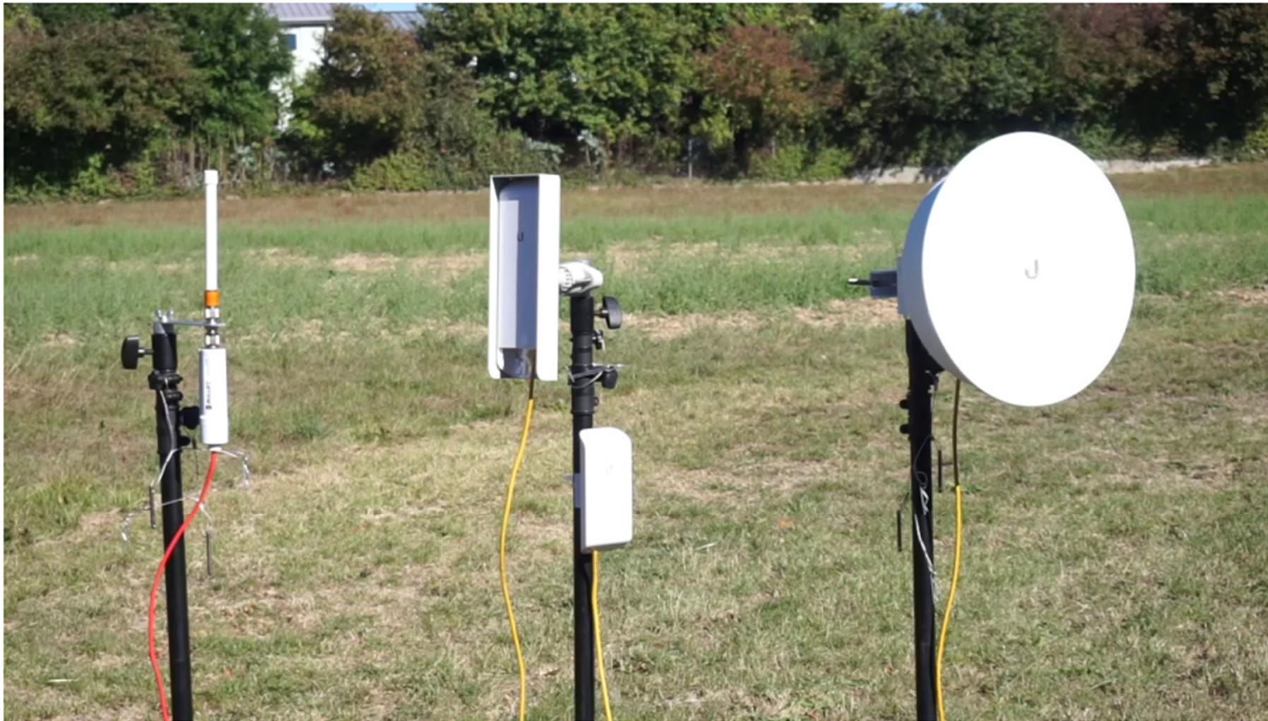
*Abbildung 1: Verschiedene Nodes. Bullet, Nanostation, Loco, PowerBeam 300 ISO (v.l.)*
