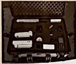
In einem stabilen Kunststoffkoffer hält die Feuerwehr des Kreises Soest auch ein **Satelliten-Telefon** mit Zubehör für das Iridium-Kommunikationssystem vor. Über dieses weltumspannende Satelliten-Telefonnetz ist es grundsätzlich möglich, von jedem Standort auf der Erdoberfläche mit freier Sicht zum Himmel Telefonate zu führen.
