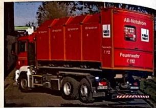
Wechselladerfahrzeug (WLF) der Feuerwehr des Kreises Soest mit AB-Notstrom. Auf dem Abrollbehälter befinden sich vier 100-KVA-Stromgeneratoren.
