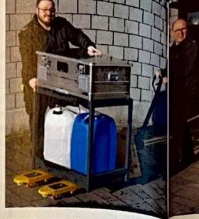
Auf einem Rollwagen hält der Kreis Soest in einer leicht transportierbaren Metallbox eine **Brennstoffzelle** (Hersteller: EFY) und eine 12-V-Pufferbatterie vor. Auf der unteren Ebene des Rollwagens lagern ein 60-l-Kanister (weiß) mit Methanol, das für den Betrieb der Brennstoffzelle benötigt wird, sowie ein Behälter (blau) zum Auffangen des bei der Stromerzeugung entstehenden Kondenswassers.
