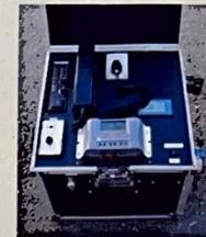
Diese **mobile Relaisstelle** für das 4-m-Band kann von nur einer Person auf jedem erhöhten Standort (wie Kirchturm oder Silo) in Betrieb genommen werden. Die Stromversorgung erfolgt über einen 12-Volt- oder 230-V-Stromerzeuger oder mithilfe von Solarpanels. Im unteren Teil der Transportbox befinden sich neben einer 12-V-Pufferbatterie mit 100-Wh-Leistung auch ein Ladegerät sowie ein 230-V-Wechselrichter.
