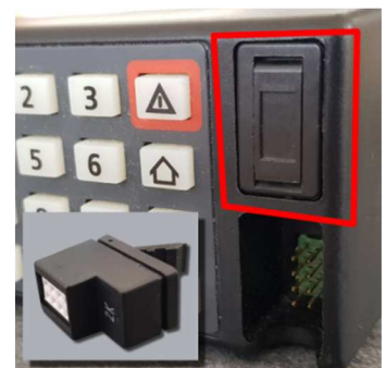
Bild 1: Kodierstecker eines Ascom SE-550 Betriebsfunkgerätes
