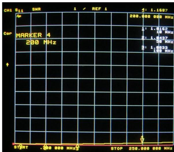
S11 SWR 300 kHz bis 250 MHz
