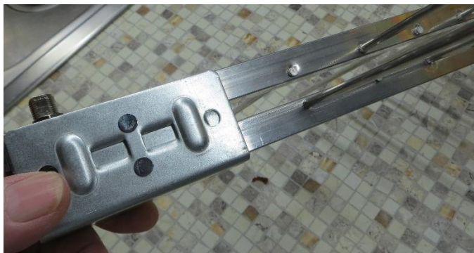
Bild 14: Abstand letztes Element zum Kurzschluss (gleichz. Mastbefestigung)
