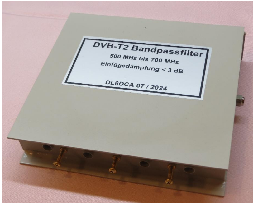
Bild 11: fertiges und lackiertes Bandpassfilter
