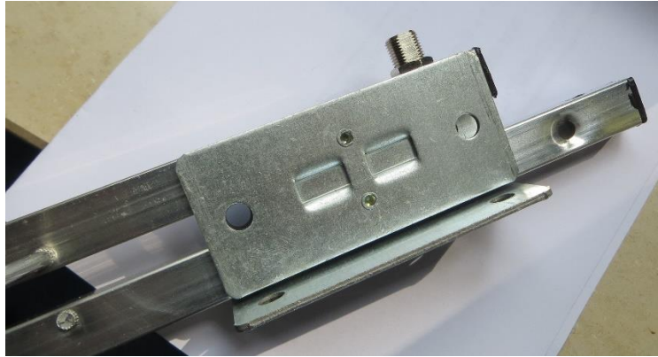
Bild 15: Halter (=Boom-Kurzschluss) und N-Buchse
