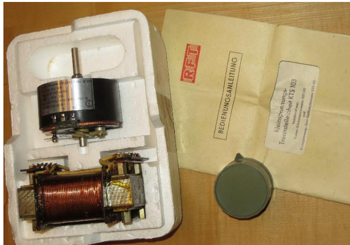
Trenn- / Stelltrafo in Originalverpackung mit Bedienungsanleitung
