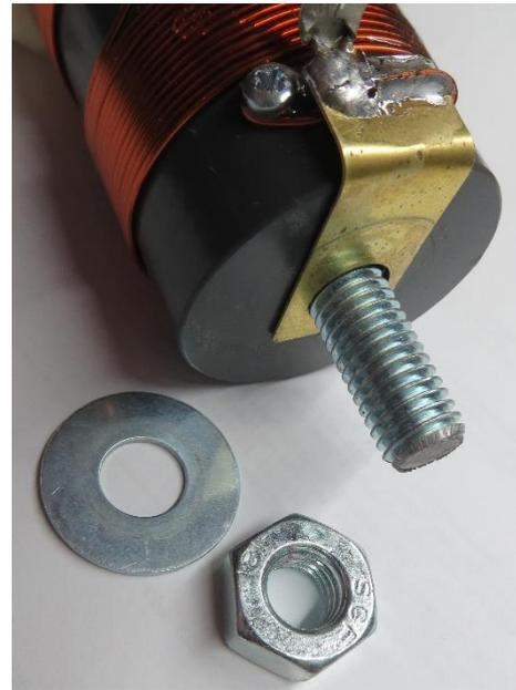
**Bilder 3 + 4: Kontaktierung Spule zu Halterung und Teleskopantenne**
