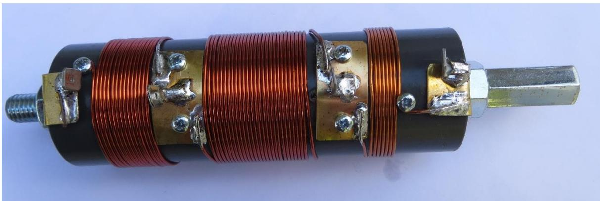
**Bild 7 Endgültige und erweiterte Verlängerungsspule**
