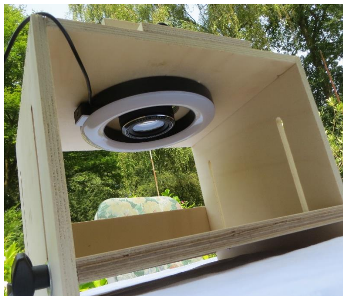
Bild 5: Innenansicht mit Ringleuchte und Kameraobjektiv
