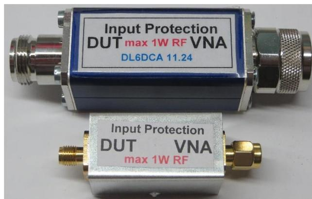
**Bild 4: In Gehäuse verbaute Schutzschaltungen**
