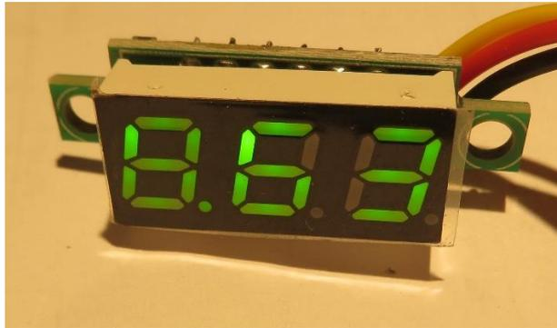
Bei der Suche nach einem Einbauvolt- bzw. Amperemeter für ein Trenntrafo Projekt sind wir über sagenhaft preiswerte LED-Voltmeter, allerdings für DC, gestolpert. 0,28“ 3-stellige Mini Digital Voltmeter für knapp einen Euro. 5 Stück mit unterschiedlichen Farben versandkostenfrei für 4,99€ und in DL lagernd. Automatisch fallen einem viele Einsatzmöglichkeiten ein. Also gleich mal zwei Beutel a 5 Stück bestellt.
