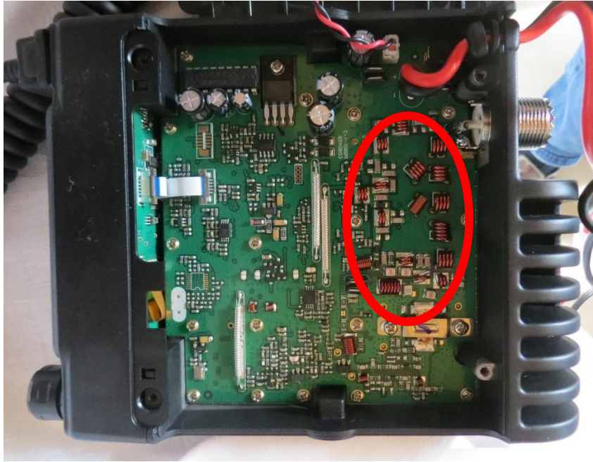
Innenansicht des RT95, hier sieht man auch die Ausgangsfilter für beide Bänder
