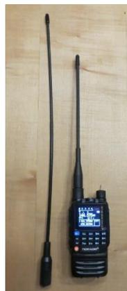
TH-3 mit kurzer und langer Antenne
