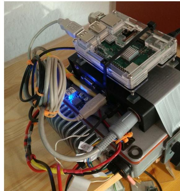
**Hier die Konfiguration: 2 m GM360 – TNC-X und Raspi 3B mit APRX Software**
