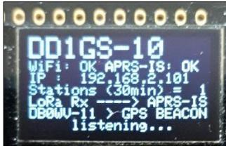
Hinter WiFi und APRS-IS müsste jetzt ein **OK** stehen und die IP-Adresse ist jetzt **192.168.2.101**. (Achtung: Eventuell kann sich bei einer **Neukonfiguration des Routers** diese IP-Adresse ändern! In der Router-Konfiguration nachsehen!
