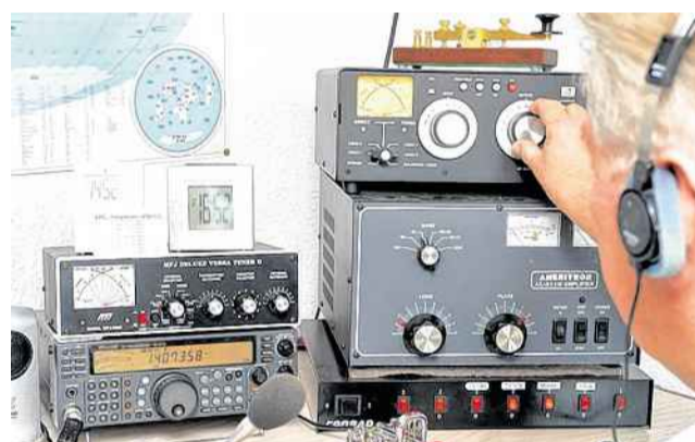
Die Hand am Regler: So wird die Antenne auf den Sender abgestimmt.
