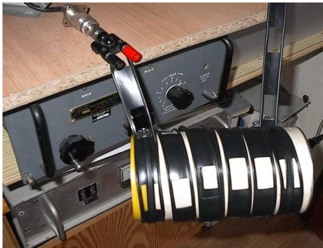
Abb.2 Beispiel eines ‚airwound‘ Balun
